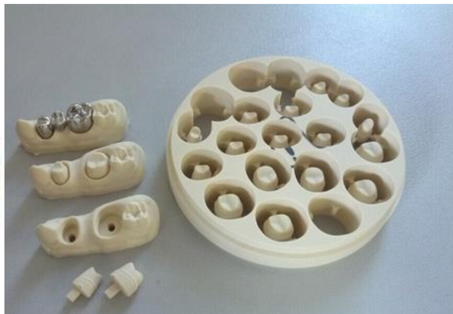
Hình ảnh sau khi tiện CAD/CAM chưa thiêu kết
